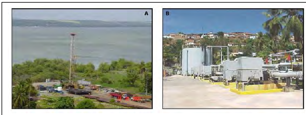
Figura 5 – Em A, sonda em operação na perfuração de poços (poço M-27D) e em B, a estação de bombeamento (cortesia Braskem).
