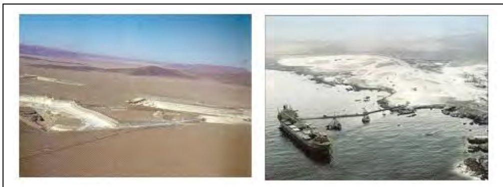
Figura 11 – Em A, lavra a céu aberto de sal no Chile e, em B, instalações portuária para o embarque do sal (Cortesia-SPL).
