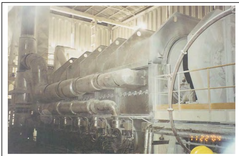
Figura 3 – Forno do tipo rotativo horizontal de queima indireta utilizado no pólo gesseiro do Araripe.
