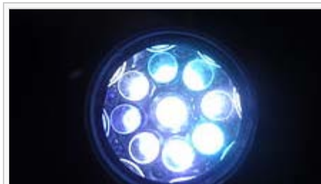
Lanterna baseada em LEDs de alto brilho com baixo consumo de energia.
